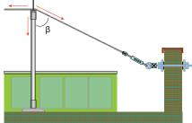
Per una corretta installazione è necessario calibrare la forza di tiro inserendo nella tesata una molla di pretensionamento e soprattutto mantenendo l'angolo β fuori dalla zona blu indicata nel grafico.
